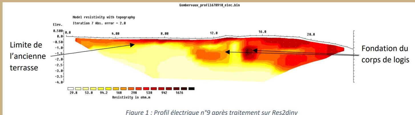
Figure 1 : Profil électrique n°9 après traitement sur Res2dinv
